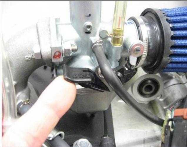
27. Choke-Hebel nach oben schieben. (wenn Motor einige Zeit gelaufen hat, kann der Hebel wieder runter).
