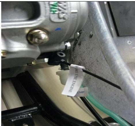
25. Entferne den Kabelbinder von der Motorentlüftung.
