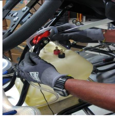
22. Montiere Kraftstoffleitung (Farbe Transparent).
