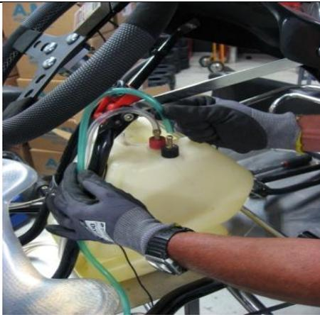
23. Montiere Rücklauf Leitung (Farbe Grün). Wenn kein Rücklauf Anschluss vorhanden ist, unbedingt im Benzintank anbringen. Benzintank füllen.
