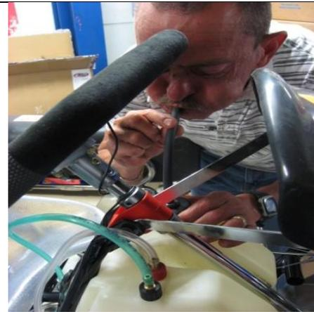
24. Puste in die Entlüftungsleitung um die Schwimmerkammer zu füllen, Während Pustens Rücklaufleitung zudrücken.
