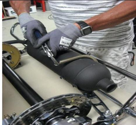
18. Auspuffedern montieren.
