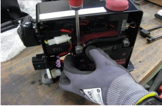
1. Entferne die Batterie aus der Batterie-Box.
