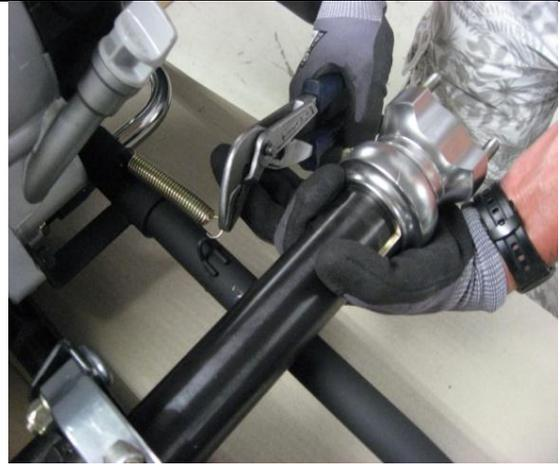
16. Auspuffedern montieren.
