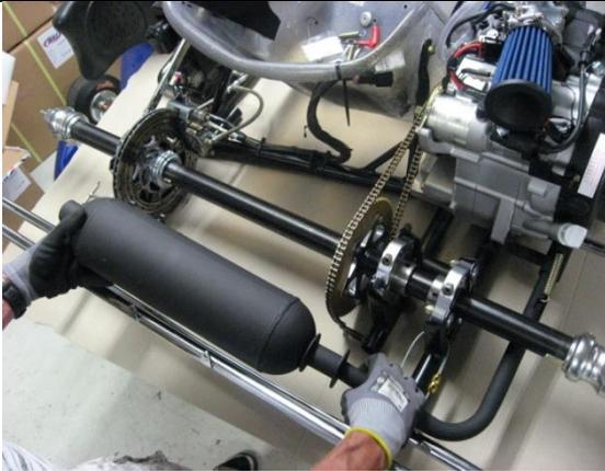
17. Abgasschalldämpfer montieren.
