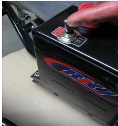
28. Abschalten des Motors durch Kontakt-Schalter auf OFF drücken.
