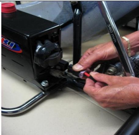
19. Kabelbaum an Batterie-Box anschließen,
