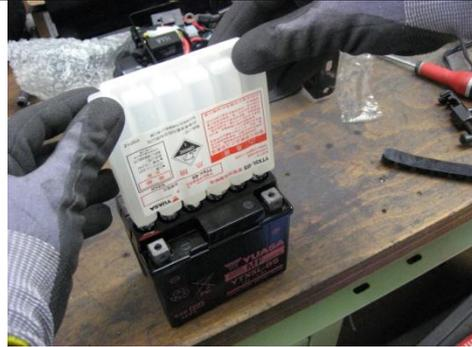
2. fülle Batterie mit Batteriesäure.
