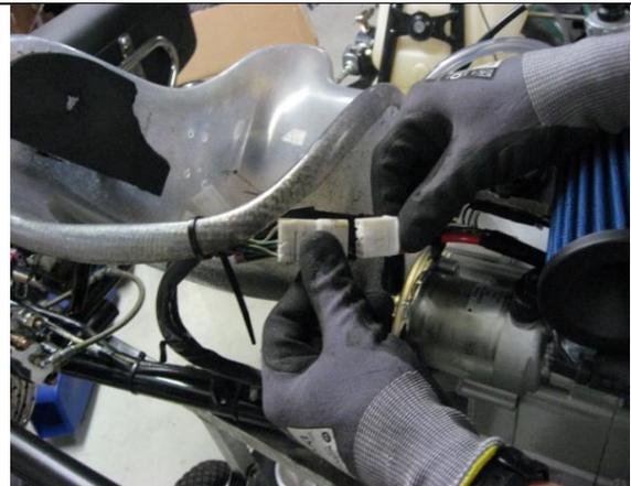
20. Kabelbaum an Motor Seite anschließen,
